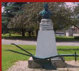
Charrue «Dombasle» (monument de son inventeur l'agronome lorrain Mathieu de Dombasle, à Dombasle-sur-Meurthe F). Ce type de charrue simple, efficace et peu coûteux connut un grand succès au 19 e siècle. Il ne présente qu'un seul versoir. Les pièces initialement en bois furent plus tard remplacées par du fer, un avant-train fut ensuite ajouté.
